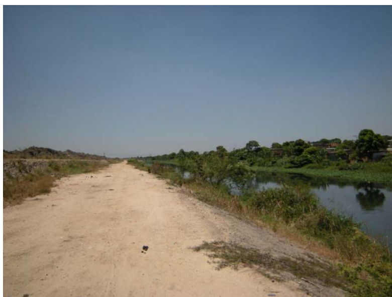
Figura 5.1.5. – Depósitos colúvio-aluvionares em ambos os lados da calha do rio Sarapuí com distribuição superficial de aterros ao longo da margem esquerda. UTM: 669906//7482246
